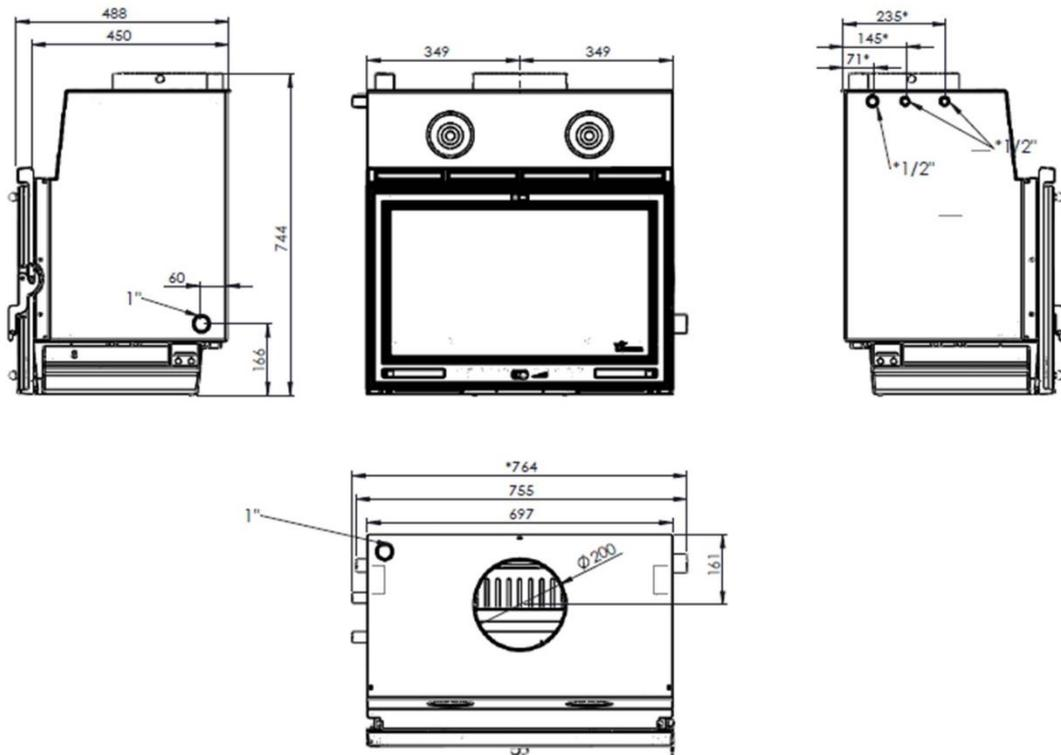
Figura n°3 - Dimensioni in mm dell'apparecchio SARRIA 12 - SAKAN 12
