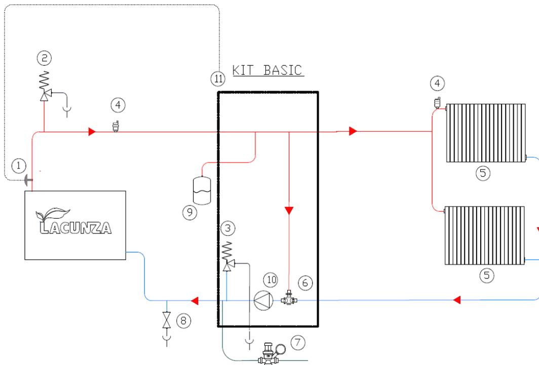
Quando l'acqua del serbatoio raggiunge i 45°C, il termostato (1) invierà un segnale al regolatore automatico (11) e questo farà funzionare la pompa di circolazione (10), fino a quando la temperatura dell'acqua non scenda a 43°C.
