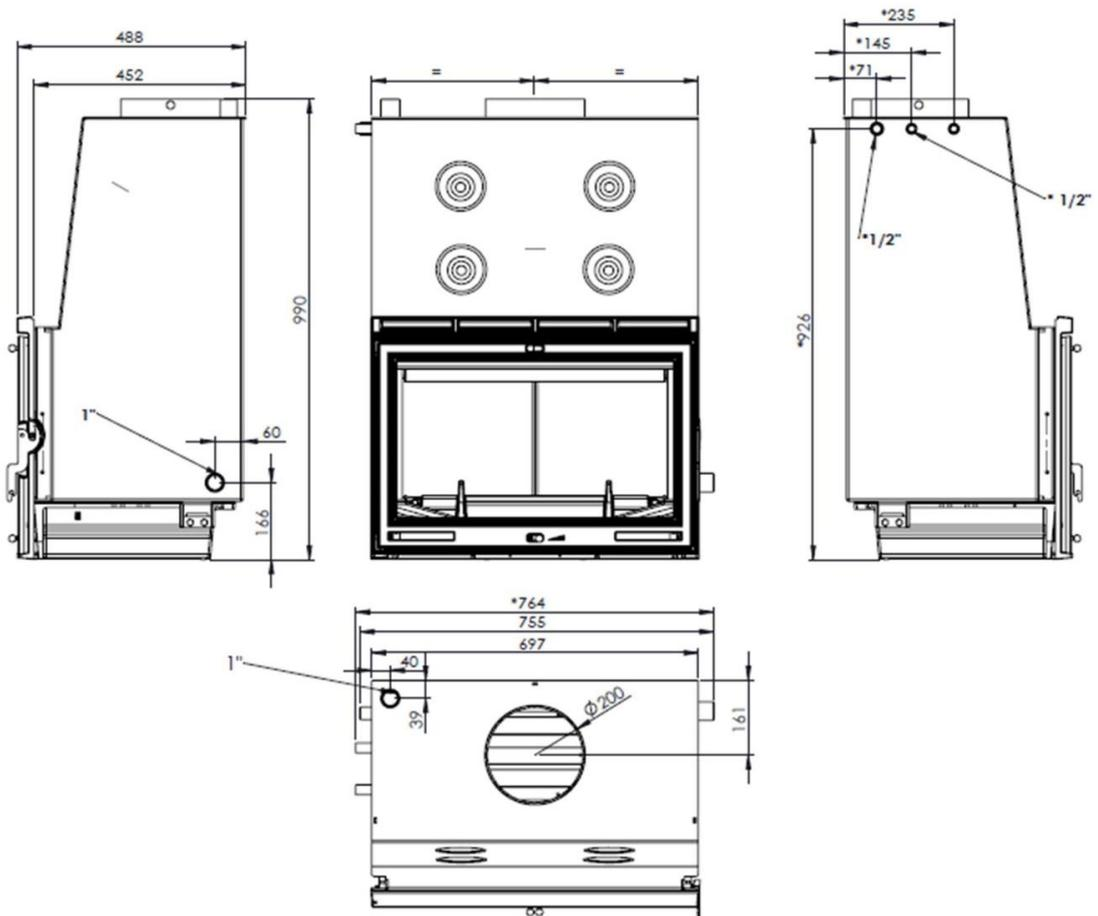
Figura n°5 - Dimensioni in mm dell'apparecchio SARRIA 16 - SAKAN 16
