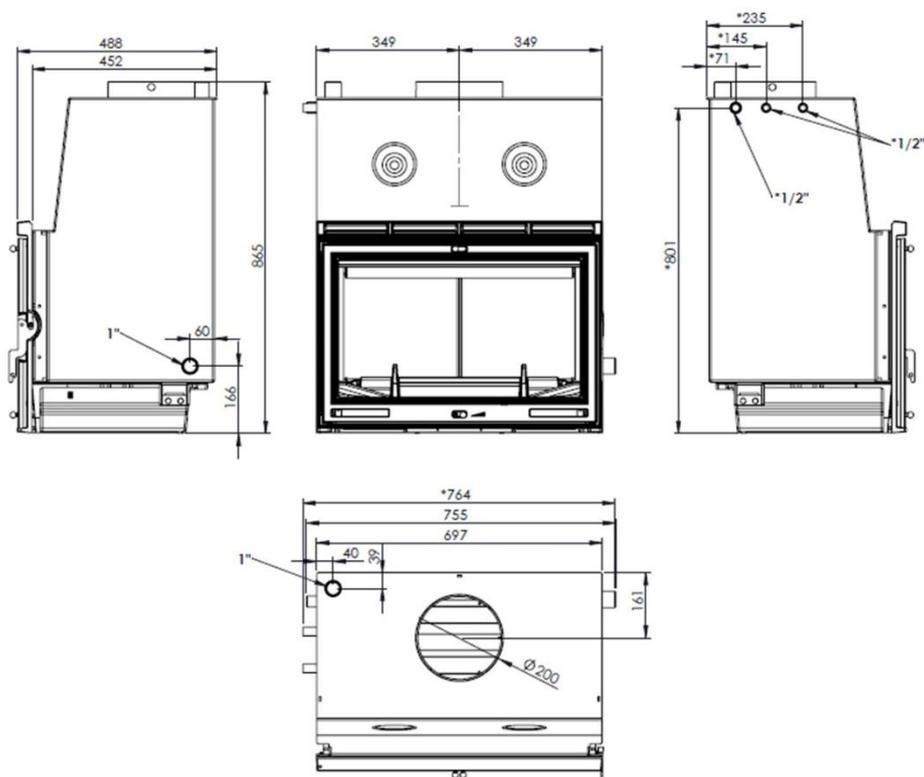
Figura n°4 - Dimensioni in mm dell'apparecchio SARRIA 14 - SAKAN 14
