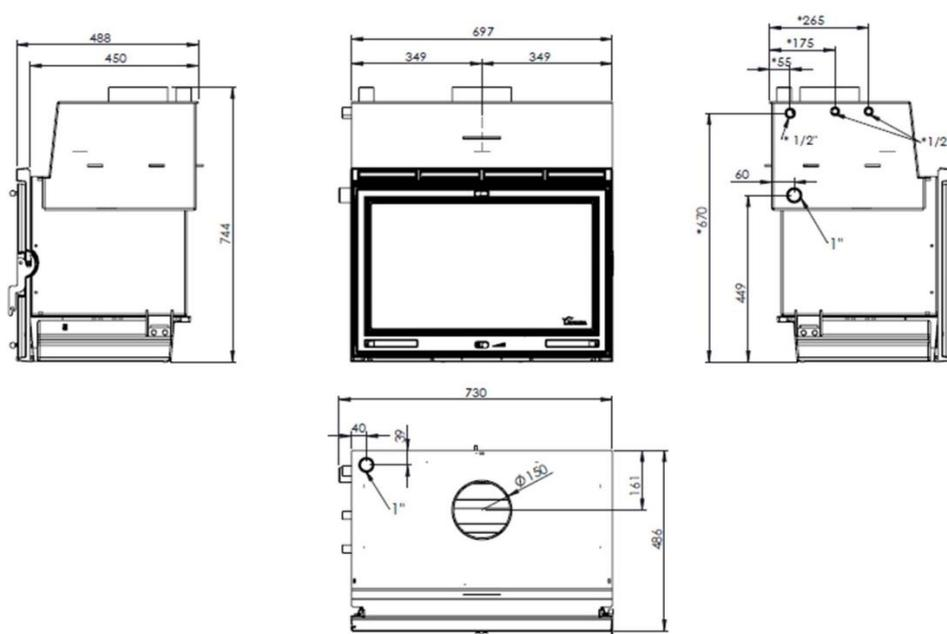
Figura n°2 - Dimensioni in mm dell'apparecchio SARRIA 9 - SAKAN 9
