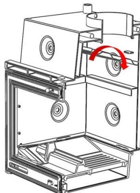
*Figura n°21 - Smontaggio del deflettore superiore Sarria-Sakan Plus*
