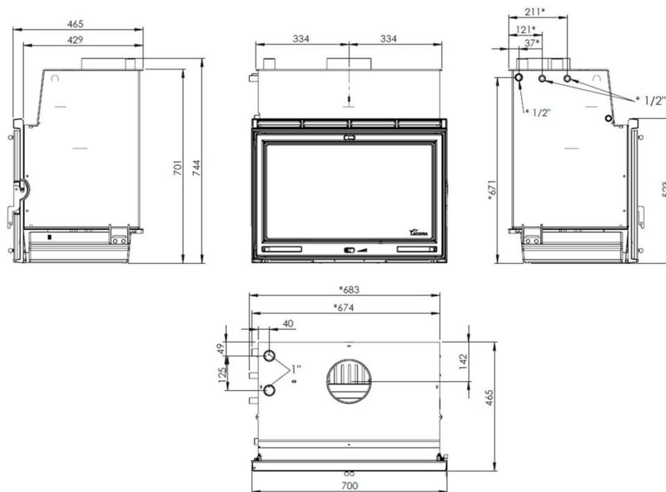
Figura n°1 - Dimensioni in mm dell'apparecchio SARRIA 6 - SAKAN 6
