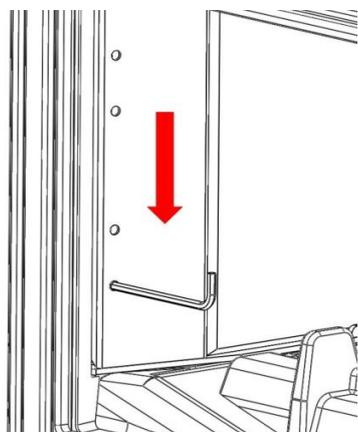
*Figura n°11 - Inserire la copertura verso il basso e stringere, introducendo la chiave nei fori.*
