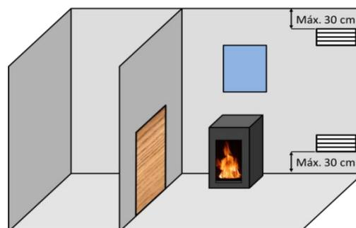
Figura n°6 - Schema orientativo per griglie di ventilazione
