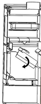
Figura n°15 - Estrazione dei deflettori in vermiculite
