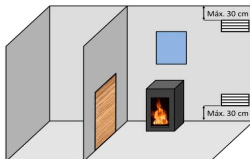
Figura n°2 - Schema orientativo per griglie di ventilazione
