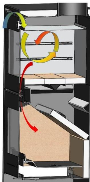
Figura n°9 - Schema sistema di estrazione di vapore
