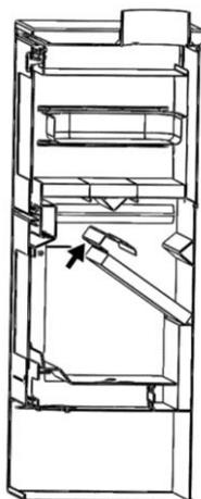
Figura n°13 - Rotazione del rinforzo in acciaio inox
