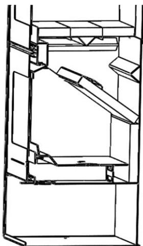
*Figura n°18 - Rinforzo di acciaio inox nella posizione aperta*
