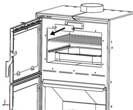
*Figura n°19 - Estrazione delle coperture di accesso*
