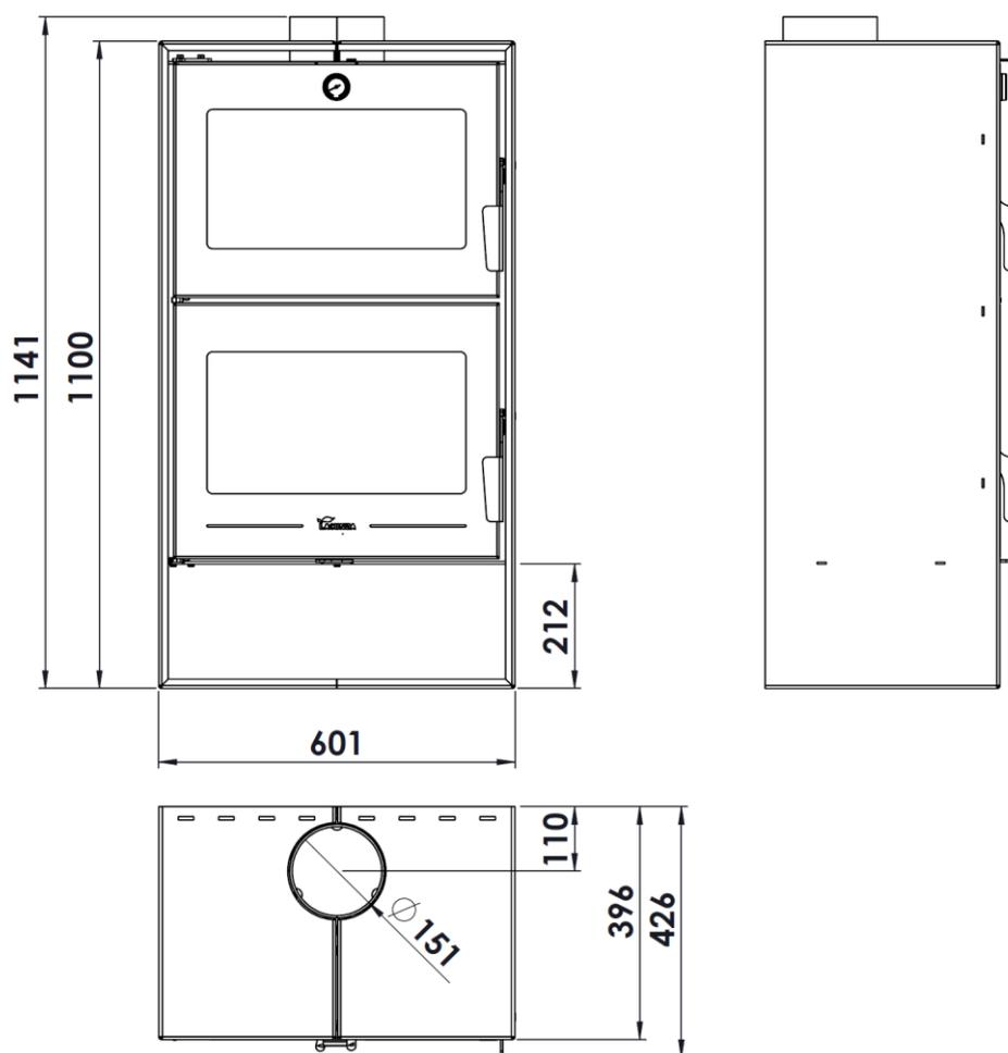
Figura n°1 - Dimensioni in mm dell'apparecchio ALTEA
