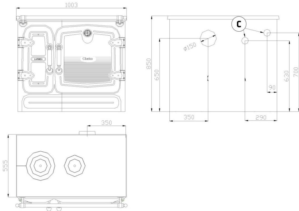
Figura n°2 - Dimensioni in mm dell'apparecchio Clásica 8TE
