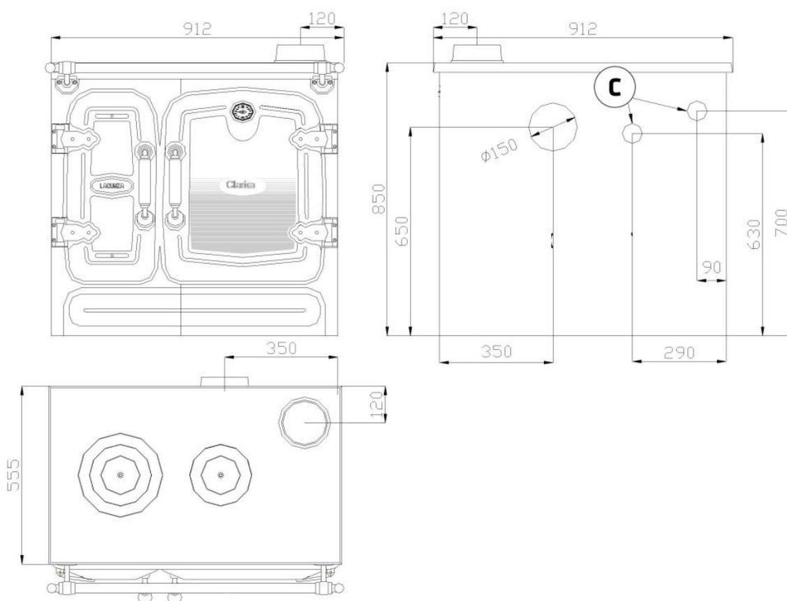
*Figura n°1 - Dimensioni in mm dell'apparecchio Clásica 7TE*
