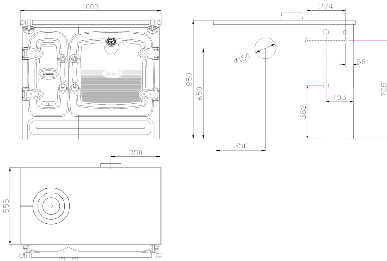
Figura n°1 - Dimensioni in mm dell'apparecchio Clásica 8TE3
