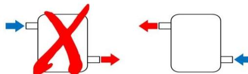
Figura n°8 - Collegamento scorretto (sin.) e collegamento corretto (dest.)
