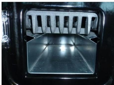
Figura n°12 - Posizione inferiore griglia
