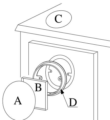
*Figura n°3 - Schema dello scarico fumi posteriore*
