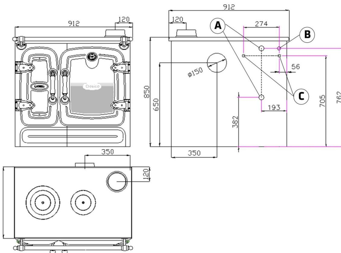
Figura n°3 - Dimensioni in mm dell'apparecchio Clásica 7TE3
