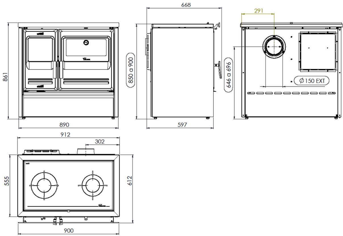
Figura n°3 - Dimensioni in mm dell'apparecchio ETNA 7T TOP
