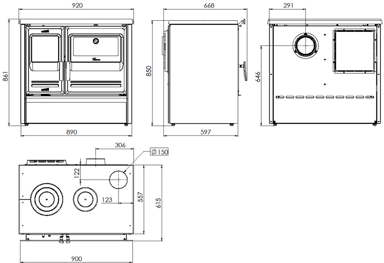
Figura n°4 - Dimensioni in mm dell'apparecchio ETNA 7T S-SUP
