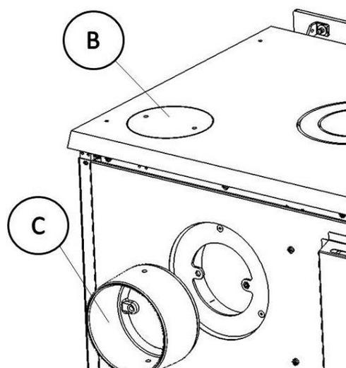
Figura n°8 - Schema dello scarico fumi posteriore
