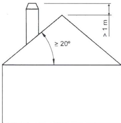
Dovrà inoltre essere 1 m al disopra della parte più alta di qualsiasi edificio od ostacolo situato in un raggio inferiore a 10 m dall'uscita del camino.
