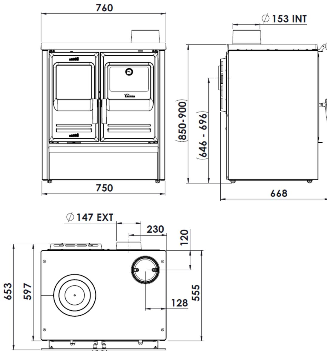
Figura n°2 - Dimensioni in mm dell'apparecchio ETNA 5T S-SUP
