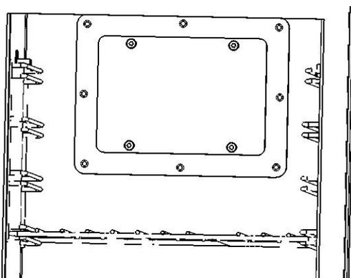
Figura n°15 - Sportello della parte posteriore del forno
