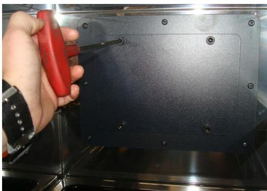
*Figura n°19 - Accesso alle viti per rimuovere la copertura del sportello*
