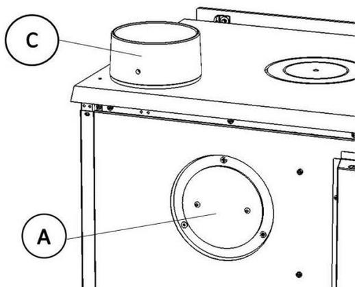
Figura n°9 - Schema per scarico fumi superiore
