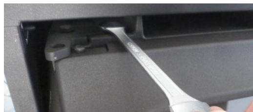
Figura n°9 - Allentare il supporto della porta con una chiave fissa da 10
