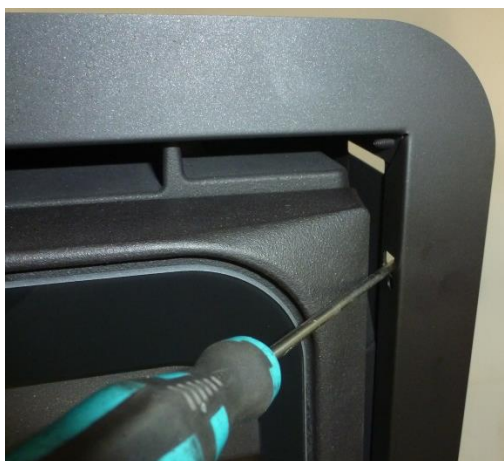
Figura n°12 - Modo di piegare le linguette
