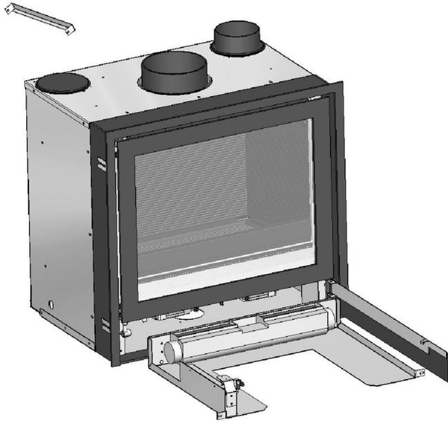
4) sfilare il cassetto contenente il ventilatore e componenti elettrici.
