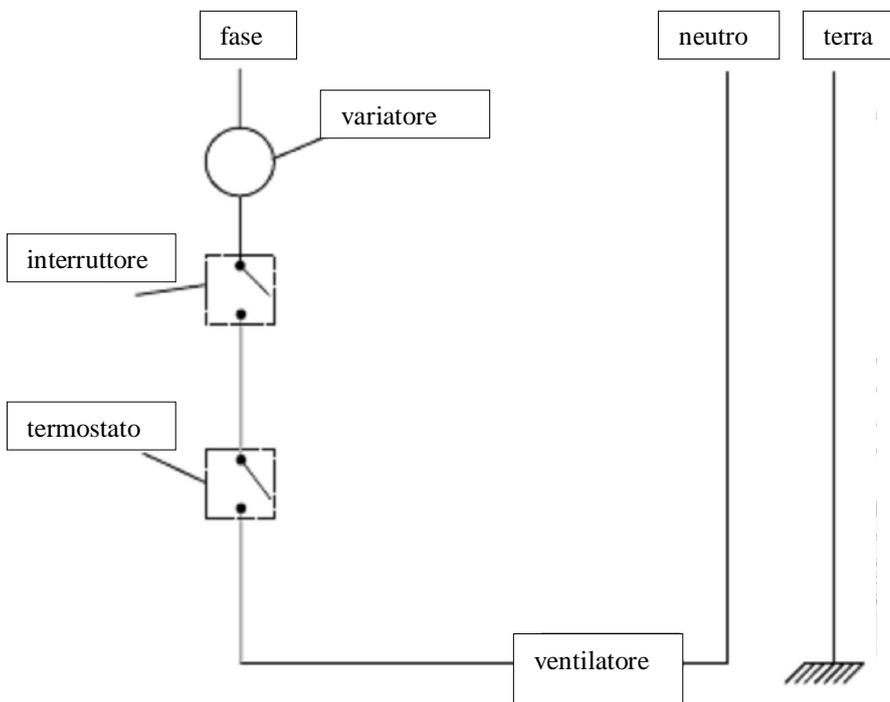
Il termostato chiude il circuito quando la sua temperatura supera i 50°C.
