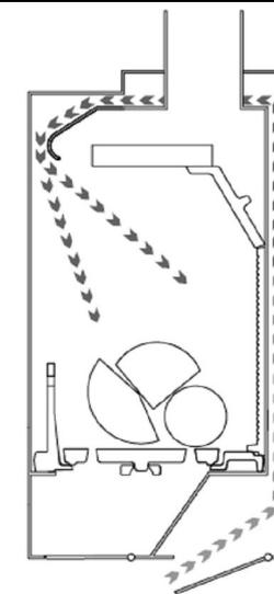
La valvola posteriore è aperta e apporta aria da sopra la griglia. Circolando nel corpo di riscaldamento, l'aria viene riscaldata prima di arrivare sulla fiamma consentendo una combustione pulita ed efficace. L'ingresso d'aria inferiore è chiuso.
