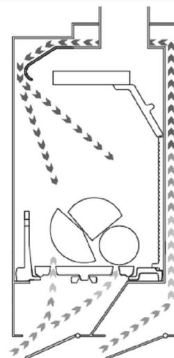
Le due valvole sono aperte per apportare una quantità massima di aria da sopra e da sotto la griglia per facilitare l'accensione.
