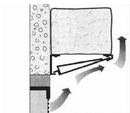
Se il caminetto è dotato di una trave in legno, è necessario isolare la parte inferiore con una protezione trave se questa si trova a meno di 30 cm dell'uscita d'aria calda
