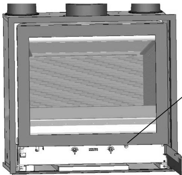
Con un cacciavite, girare in senso orario per aumentare l'ingresso d'aria minimo. Girare in senso antiorario per diminuire o chiudere completamente l'ingresso d'aria minimo.
