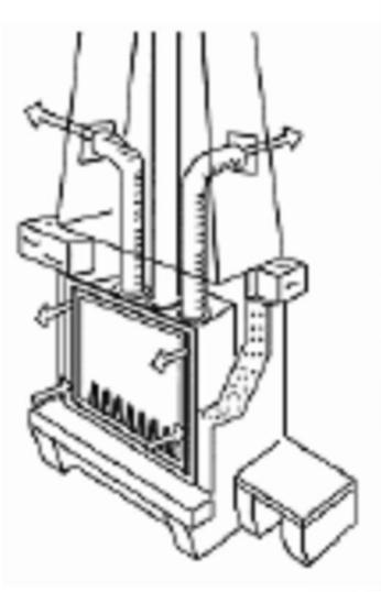
Il vostro apparecchio è dotato di un sistema per recuperare di calore e due bocchette che consentono il collegamento di tubi flessibili. I tubi flessibili possono essere orientati per poter orientare l'aria calda nelle altre stanze della casa.
