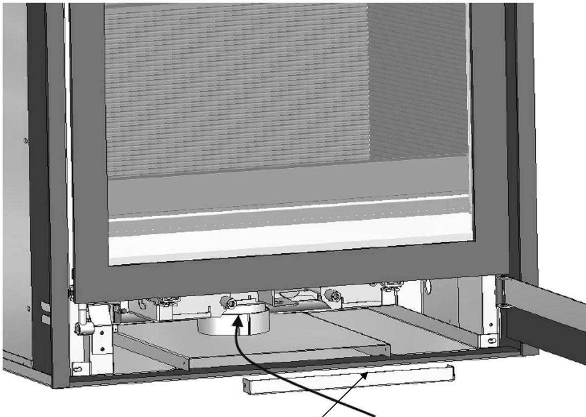
Per permettere all'aria di combustione di entrare nella stufa, rimuovere questo pezzo, svitando 2 viti
