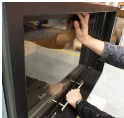
Figura n°29 - Sostenere la maniglia con una mano mentre con l'altra si tira la porta verso l'esterno.
