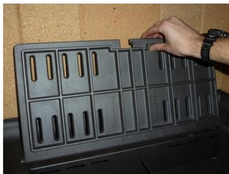
*Figura n°20 - Appoggiare la griglia sul fondo del focolare*
