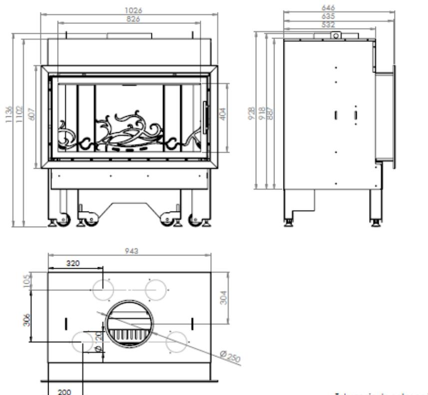
Figura n°2 - Dimensioni in mm dell'apparecchio INCA 100
