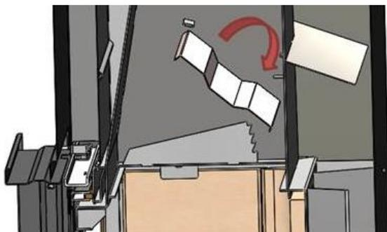
Figura n°22 - Smontaggio del deflettore intermedio Inca
