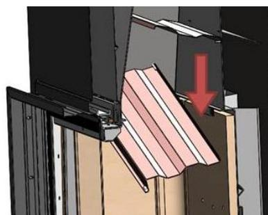
Figura n°21 - Smontaggio del deflettore inferiore Inca
