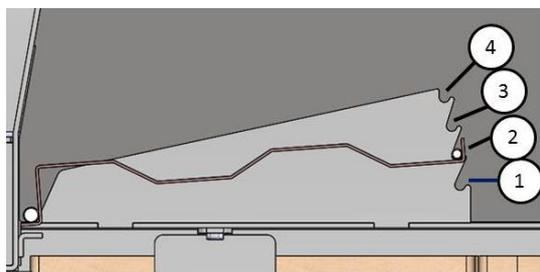
Figura n°20 - Diverse posizioni del deflettore inferiore Inca
