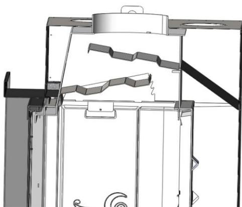
Figura n°19 - Vista in sezione con i 2 deflettori collocati
