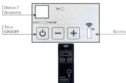
Figura n°24 - Display termoregolatore Inca
