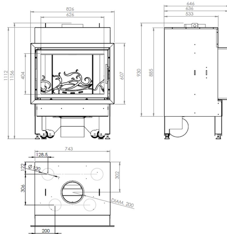
Figura n°1 - Dimensioni in mm dell'apparecchio INCA 80
