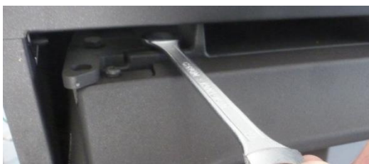
Figura n°10 - Allentare il supporto della porta con una chiave fissa da 10
