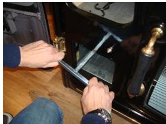
Figura n°13 - Movimento per alzare e abbassare la posizione della griglia
