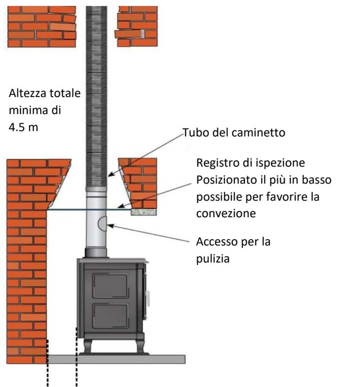
Fig. 3.- Esempio di collegamento alla canna di fumaria in muratura
