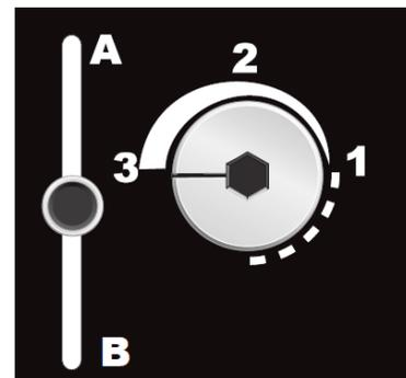
**Manopola- per regolare l'andamento del fuoco.** Quando la manopola è girata a sinistra, la camme apre progressivamente l'aletta per aumentare il flusso dell'aria primaria.
