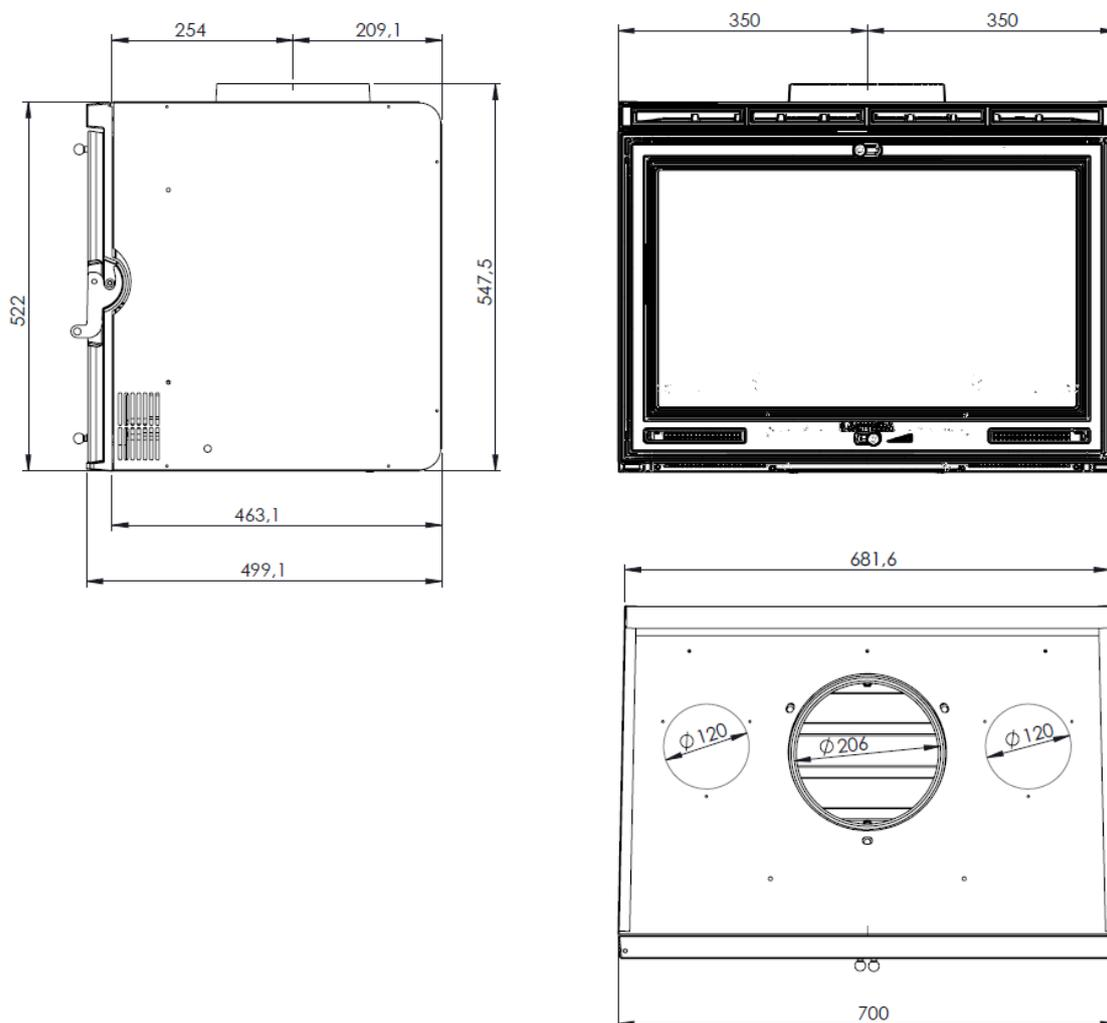
Figura n°1 - Dimensioni in mm dell'apparecchio MIDI-700
