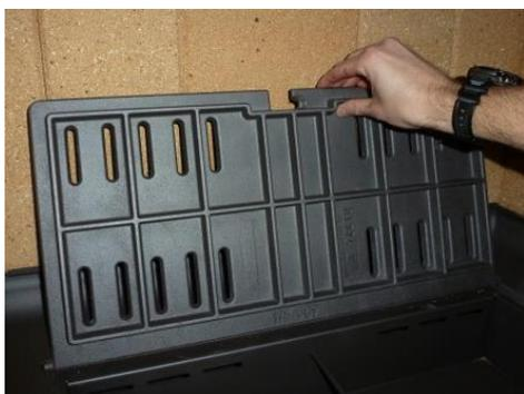
Figura n°18 - Appoggiare la griglia sul fondo del focolare
