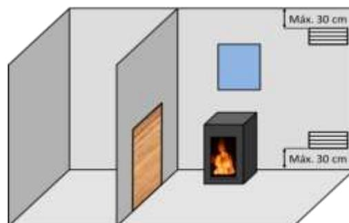
Figura n°4 - Schema orientativo per griglie di ventilazione
