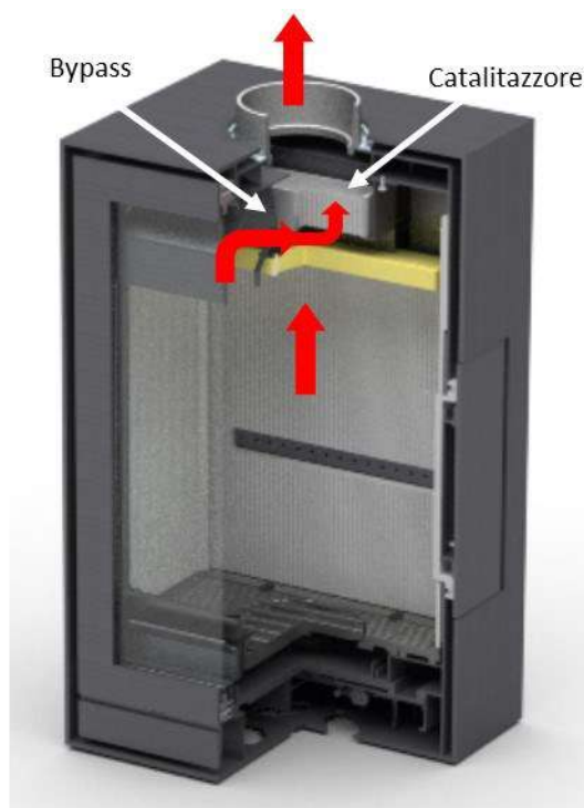
Fig. 10. Circolazione di fumo con bypass chiuso
