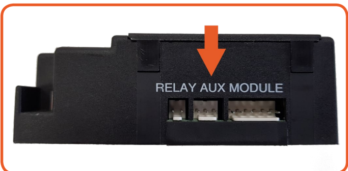
Figura A.11 - Posizione Aux ricevitore
