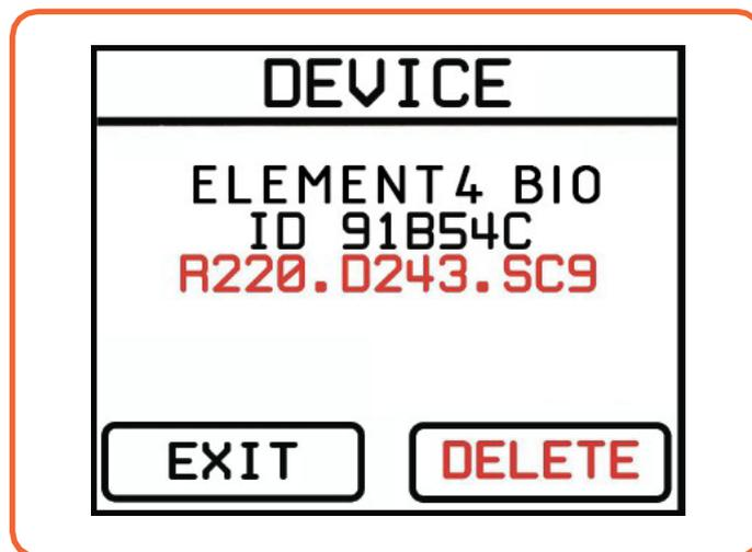
Fig. 13.7 Il codice di errore visualizzato sul trasmettitore portatile
