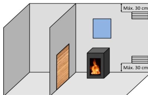
Figura n°9 - Schema orientativo per griglie di ventilazione
