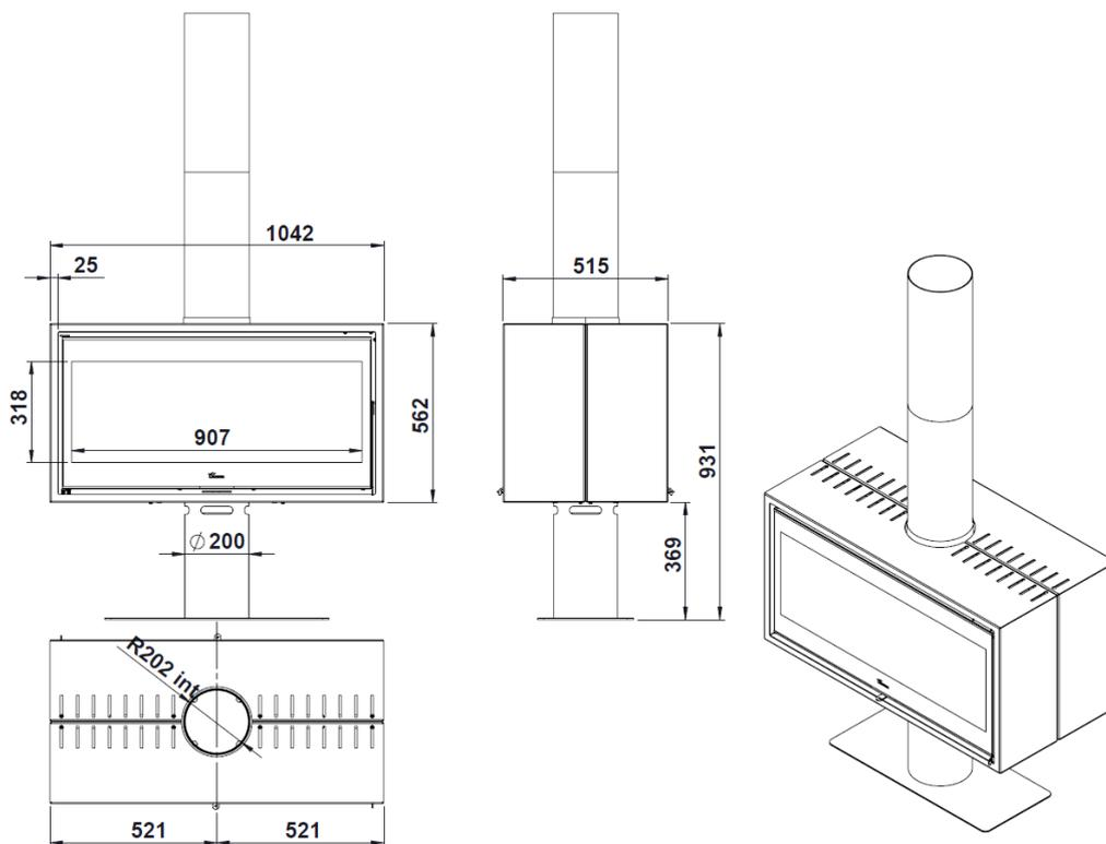
Figura n°4 - Dimensioni in mm dell'apparecchio Verona 1001
