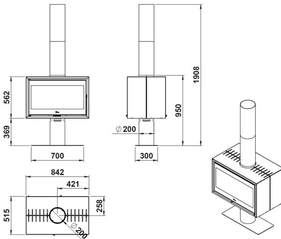
Figura n°2 - Dimensioni in mm dell'apparecchio Verona 801
