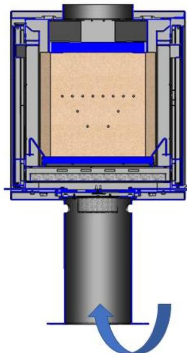
*Figura n°12 - Conduzione dell'aria per camera di combustione Verona 801-1001*
