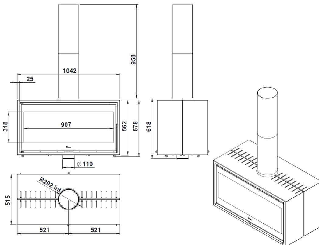
Figura n°3 - Dimensioni in mm dell'apparecchio Verona 1000
