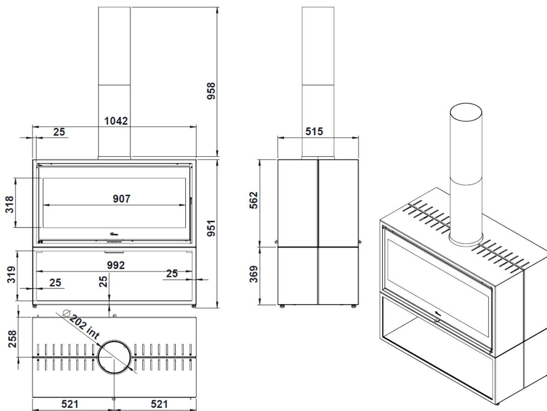
Figura n°5 - Dimensioni in mm dell'apparecchio Verona 1003
