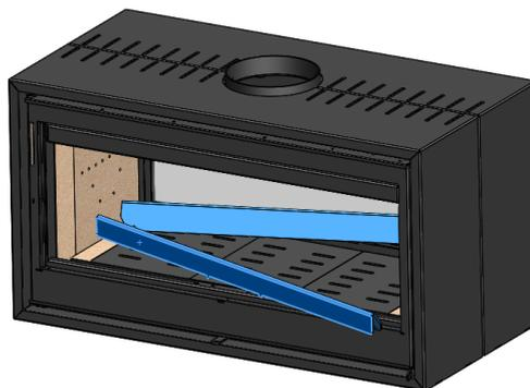
Figura n°19 - Estraiamo i due separatori del focolare
