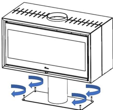
Figura n°10 - Fissaggio al suolo del Verona 801-1001
